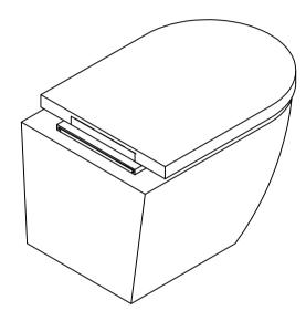
SLIDE THE SEAT AND HINGE PLATE BACK INTO POSITION AND FIX USING THE RETAINING SCREWS.
