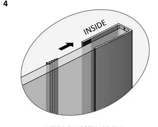
INSERT PUSH IN 'V' SEAL AS SHOWN:
