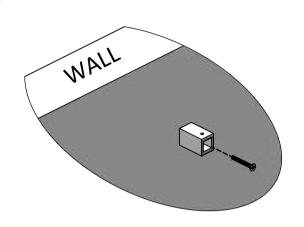
ONCE ASSEMBLED MARK AND DRILL THE TOP BAR WALL SOCKET (ITEM 5). ENSURE THE TOP BAR WALL SOCKET IS LEVEL AND THAT THE GRUB SCREW IS FACING UPWARDS BEFORE FIXING IT TO THE WALL USING ITEMS 10 & 12.
