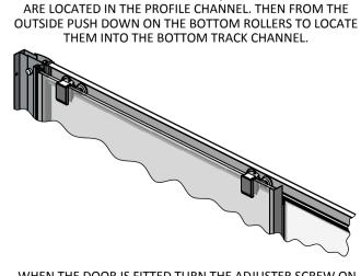
WHEN THE DOOR IS FITTED TURN THE ADJUSTER SCREW ON THE TOP ROLLERS TO LEVEL THE DOORS WITH THE MAGNETIC PROFILE AND MAKE THEM TRUE TO EACH OTHER.
